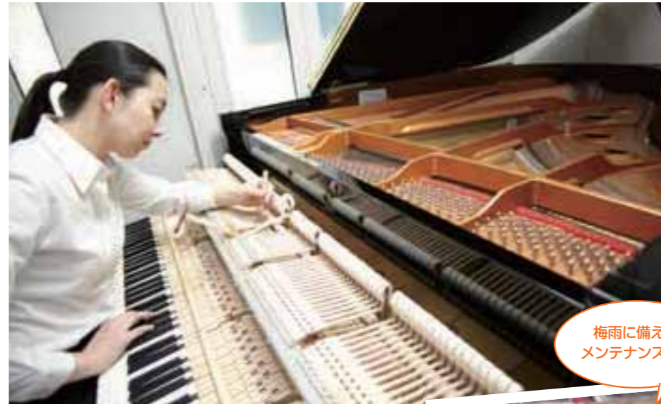
内部ハンマーが正しく機能するよう調整する「整調」によってタッチも音も変わる。
