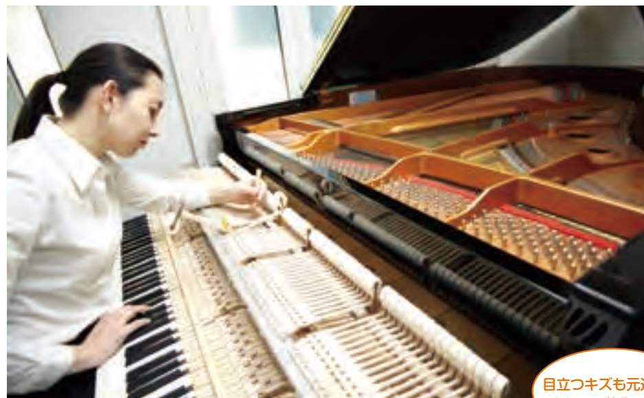
微妙な狂いを見極めながら、タッチも音も大きく変わる内部ハンマーを整調。
