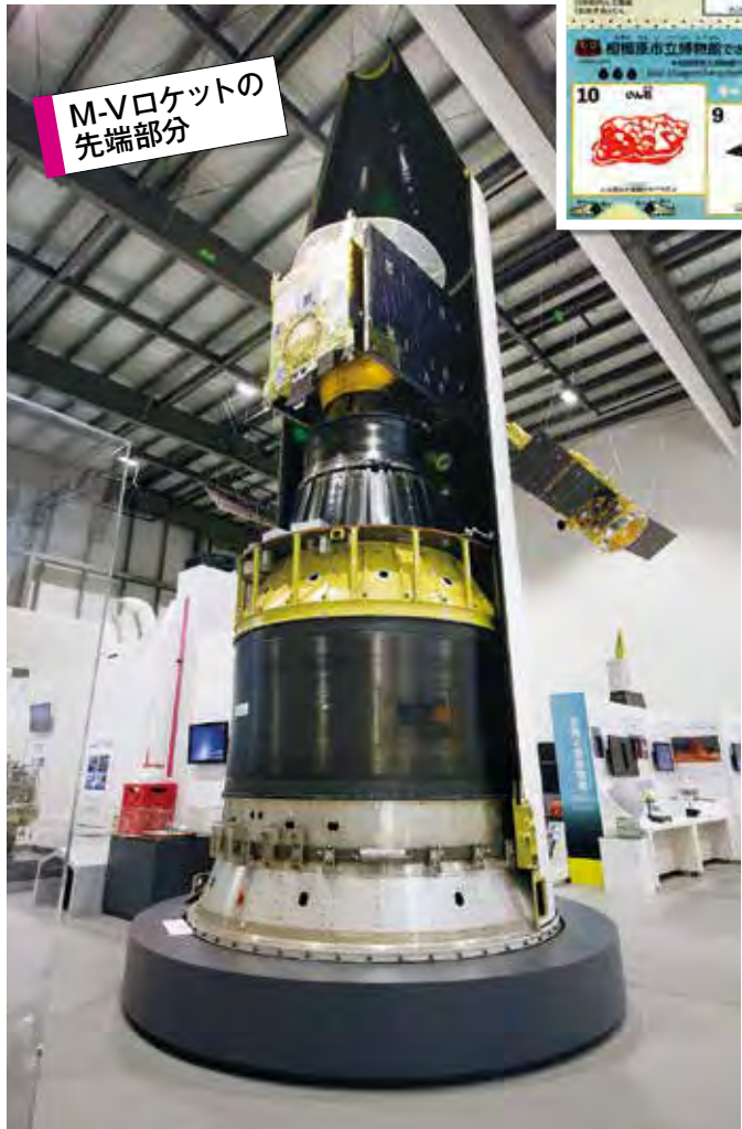
「はやぶさ」を搭載して打ち上げられたM-Vロケットの先端部分。高さ約9mあり、大迫力だ。内部の構造がわかるようにノーズフェアリングと呼ばれる外壁が半分外され、内部の固体燃料を入れる炭素繊維強化プラスチック(CFRP)に直接手で触れられる工夫もしてある。
