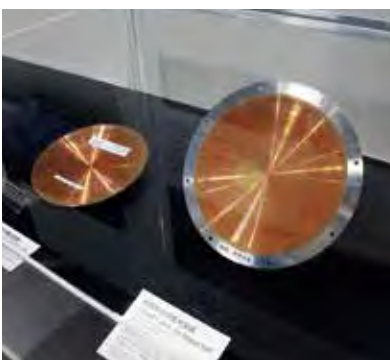
2 「はやぶさ2」に搭載した衝突装置によって、「リュウグウ」の表面に人工のクレーターを作り、地下部分からのサンプルを採取する。
