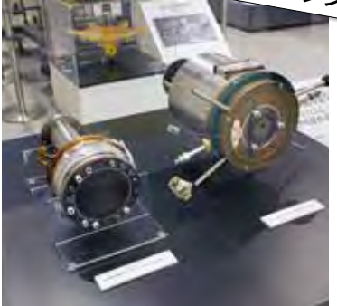
はやぶさ2やはやぶさに搭載されているイオンエンジンの実験機も展示。キセノンガスをマイクロ波でプラズマ状態にし、イオンを高速で噴射する。
