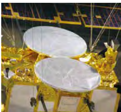
1 平面アンテナのほうがパラボラよりも軽く、熱も集めにくい。周波数の違うアンテナを2つ搭載している。
