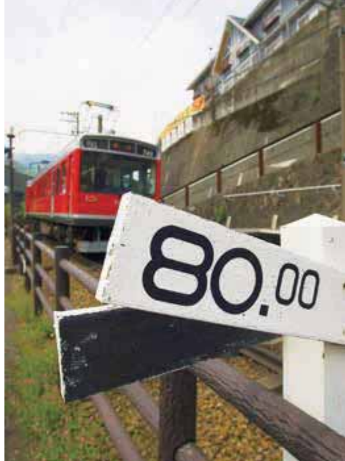
1kmごとに80mを登る急勾配を、進行方向を変えるスイッチバックで進む(左・下)。登山鉄道ならではの過酷な環境の中、従業員一丸となって、より安全で快適な運行を目指している。
