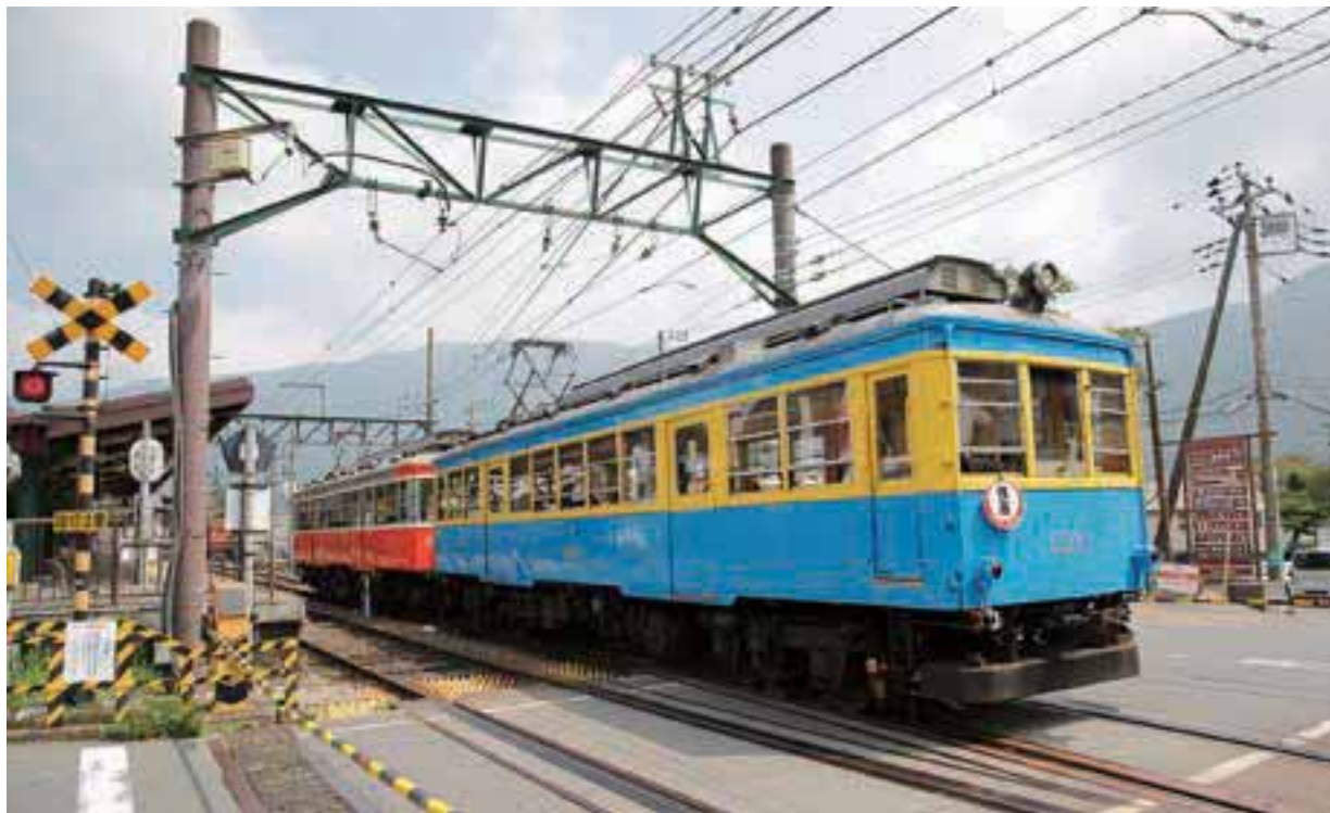
モハ1形、2形、1000形、2000形、3000形、3100形と、新旧の車両が活躍している。写真はモハ1形。当初は両運転台の車両だったが、1993年に中央の運転台を撤去して、2両固定編成に。
