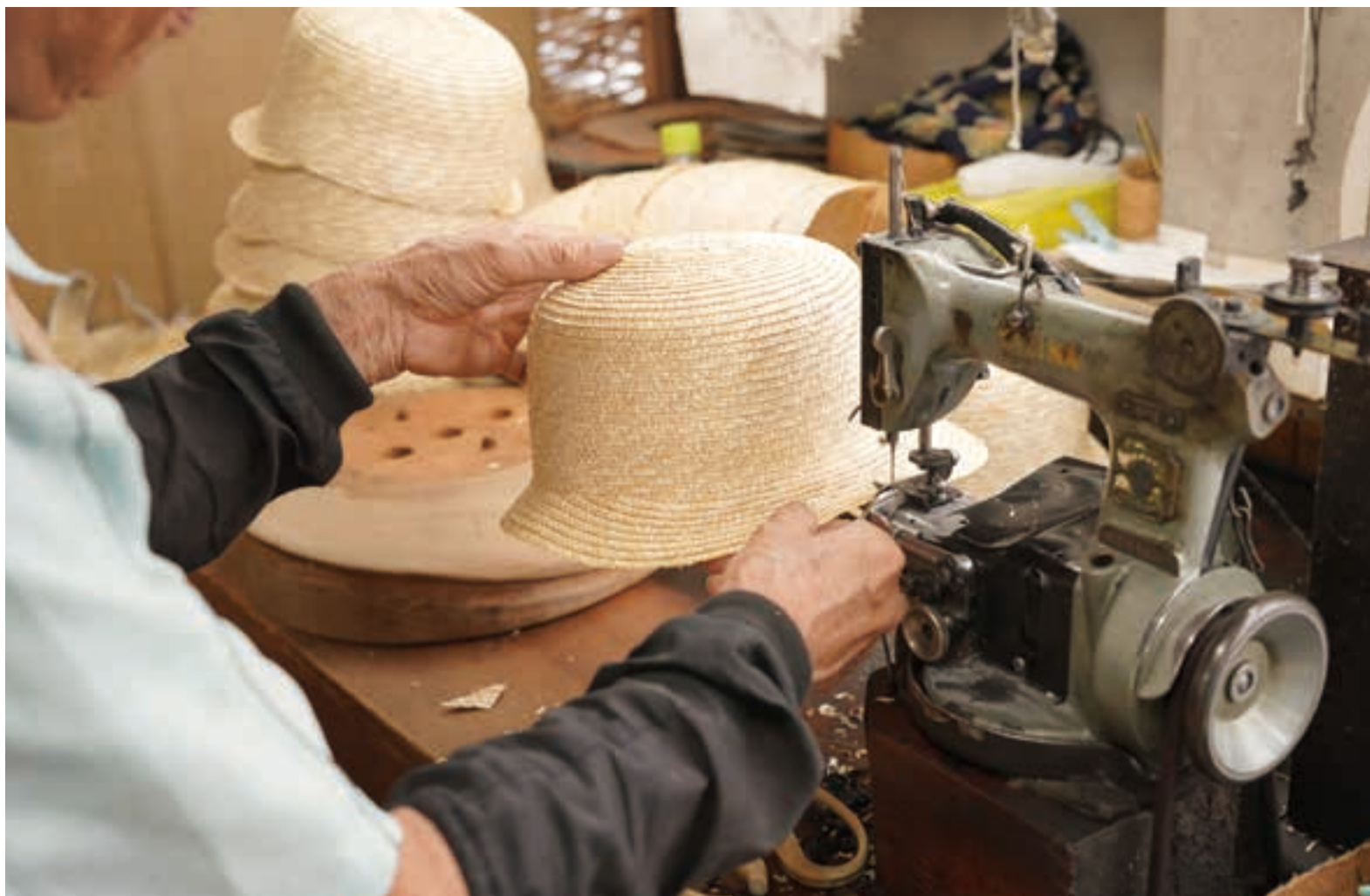
40年は使続けているというミシンは、「環縫いミシン」と呼ばれる帽子専用のもの。下糸を使わず編むように縫うため、ふんわり柔らかく仕上がるのが特徴だ。
